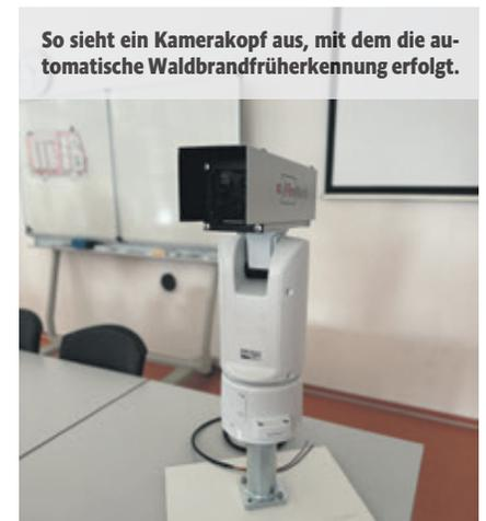
So sieht ein Kamerakopf aus, mit dem die automatische Waldbrandfrüherkennung erfolgt.
