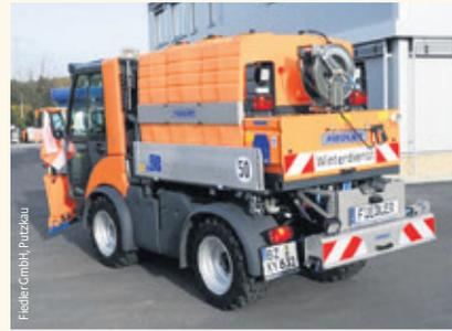
Beispielfoto eines ähnlichen Fahrzeuges mit FSSA 2000 mit Wassertanksystem (Sommernutzung) und Solesprühanlage (Winternutzung)
