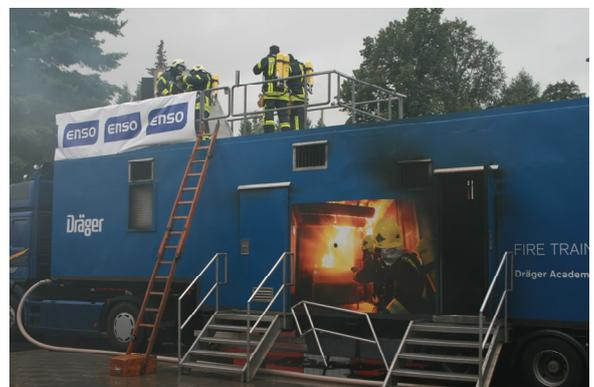
In dem mehr als 40 m<sup>2</sup> großen Übungscontainer werden unterschiedliche Einsatzszenarien simuliert, beispielsweise Zimmer-, Treppen-, Verteilerkasten- oder Gasleitungsbrände. Mit 300 bis 600 °C herrschen reale Einsatzbedingungen.
