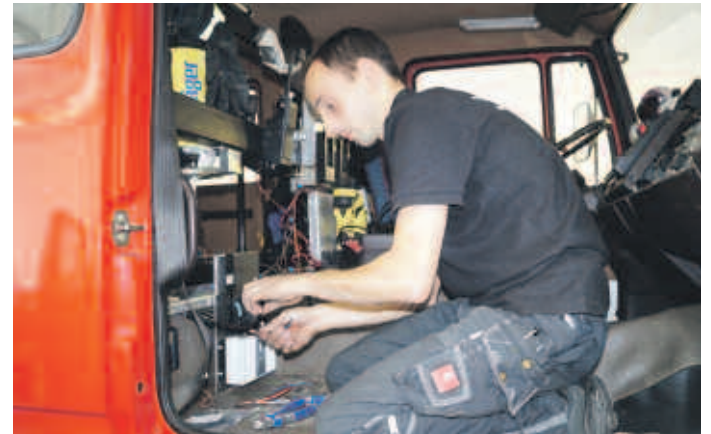
Mitarbeiter der Firma Seltronik Nachrichtentechnik GmbH aus Cottbus baut ein Fahrzeugfunkgerät in ein Tanklöschfahrzeug der FFW Weißenberg ein
